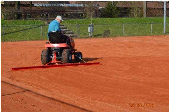
Afbeelding: egalisatiebalk drie meter breed
