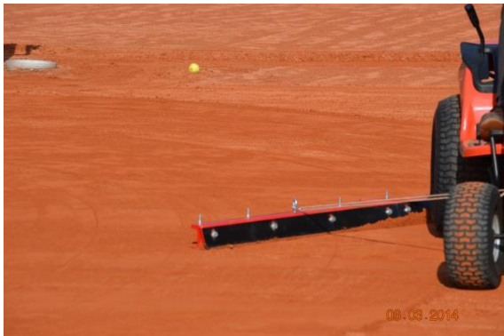
Afbeelding: egalisatiebalk drie meter breed
