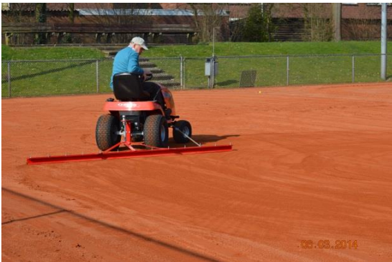
Afbeelding: egalisatiebalk drie meter breed
