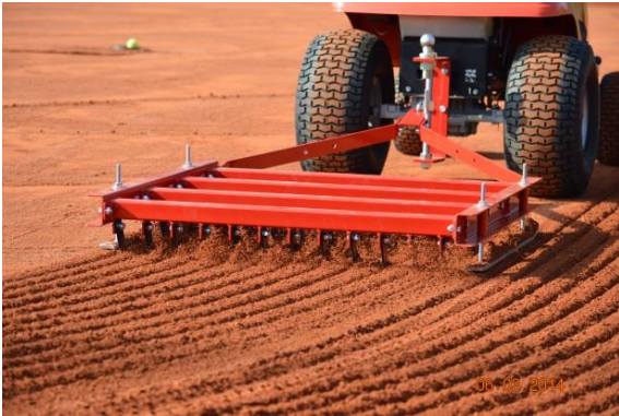
Afbeelding: baaneg met diepte-instelling
